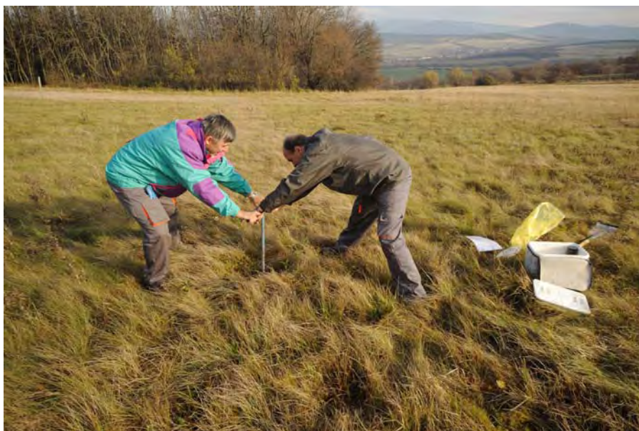
Popis ilustrace: Odběry půdních vzorků pro studium půdní makrofauny v travních ekosystémech pomocí speciální sondy.
