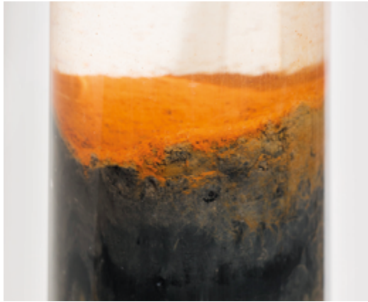
A freshly formed iron hydroxide layer on the top of the sediment after one week exposure of the sediment core to oxic atmosphere. / Čerstvě vysrážená vrstva hydroxidu železitého po vystavení sedimentu oxické atmosféře po dobu jednoho týdne. Foto: P. Porcal.
