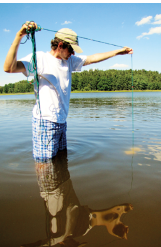
Measurement of transparency using Secchi disk in Kačležský Pond. / Měření průhlednosti Secchiho deskou na Kačležském rybníce. Foto: I. Matějčková.
